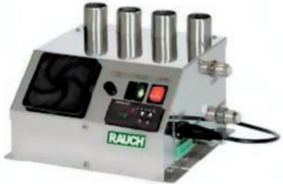
Die fortschrittliche Technik ermöglicht die universelle Anwendung und einen wirtschaftlichen Betrieb - nur ~52W/h elektrische Leistungsaufnahme für 1 kg Feuchte. Luftbefeuchter eignen sich besonders zur gleichzeitigen Befeuchtung und Kühlung. Die elektrische Energieeinsparung gegenüber isothermen Befeuchtungssystemen (z.B. Dampfbefeuchter) ist dann besonders groß (bis zu 93%).
